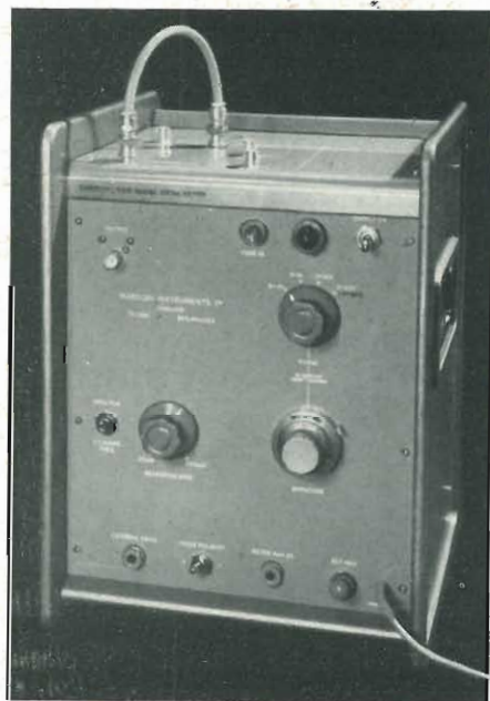
La MARCONI INSTRUMENTS ha presentato recentemente un nuovo generatore d'impulsi, tipo TF1389. Esso consente di ottenere impulsi con tempo di formazione molto breve, di polarità positiva o negativa. Può trovare utile impiego nel controllo di amplificatori, oscilloscopi, e può essere anche usato quale generatore per modulazione d'impulsi.
