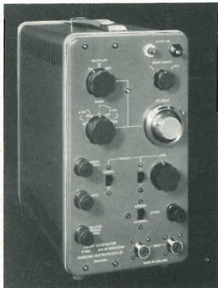
Questo nuovo generatore MARCONI INSTRUMENTS a ritardo, tipo TF1415, consente di ottenere dei ritardi progressivi quando è usato con l'oscilloscopio TF1330, o ogni altro oscilloscopio. Alternativamente, esso può venir usato indipendentemente come generatore di ritardi a scopo generale.
